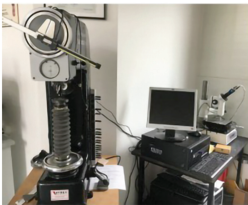
Dia Testor modernizat cu balanță digitală și testXpert III
