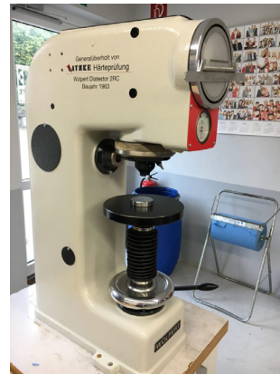
Zwick 3202 modernizat cu sistem video și testXpert Dia Testor 2 Rc din 1963, complet modernizat
